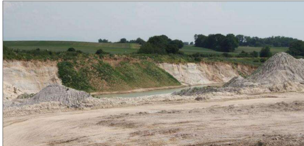
L'exploitation sous l'eau a commencé mais se limite à 4 à 5 m de profondeur. Si Fulchiron Alsace obtient l'autorisation préfectorale, elle pourra extraire des sables jusqu'à 23 m de profondeur à l'aide d'une drague. Photo DNA/Véronique KOHLER
